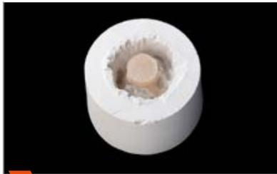
**4** Realize a desinclusão grosseira com  $\text{Al}_2\text{O}_3$  (tamanho de grão de  $50\ \mu\text{m}$ ) a uma pressão de 4 bar.
