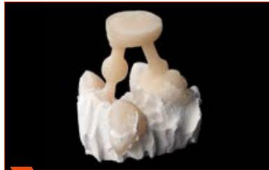
**5** Desinclusão fina e remoção da camada de reação a uma pressão de 2 bar.
