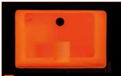
**4** Coloque a mufla no forno com a abertura voltada para baixo. Nenhum contato com a parede do forno.
