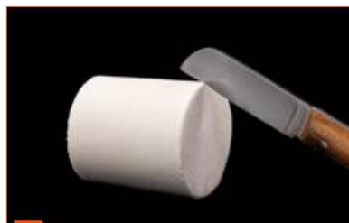
**3** Quebre as bordas da mufla sem que o material de revestimento caia no canal.
