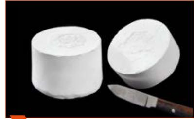
**3** Divida cuidadosamente a mufla com uma faca no ponto de ruptura predeterminado.
